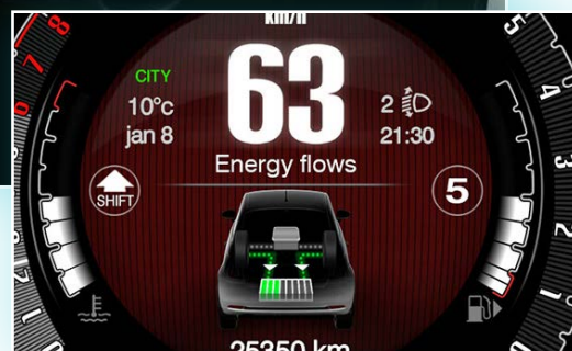
Wyświetlacz 7-calowy TFT - elektroniczny wyświetlacz zegarów i komputera pokładowego
