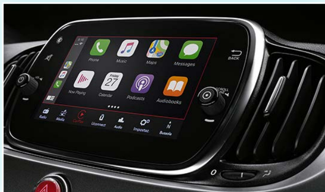
Radio Uconnect DAB z 7-calowym dotykowym ekranem, portem USB i systemem Bluetooth
