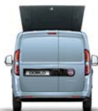
Uchylny dach nad przestrzenią ładunkową (opcja 585) dostępny tylko w wersjach z tylnymi drzwiami dwuskrzydłowymi, pełnymi lub przeszklonymi
